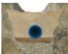
Traditionell läggning i schakt.
