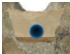
Traditionell läggning i schakt.
